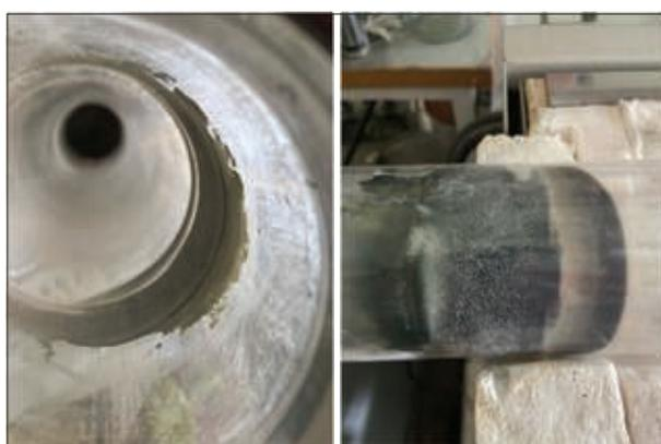
Рис. 8. Налет на стенках реактора
