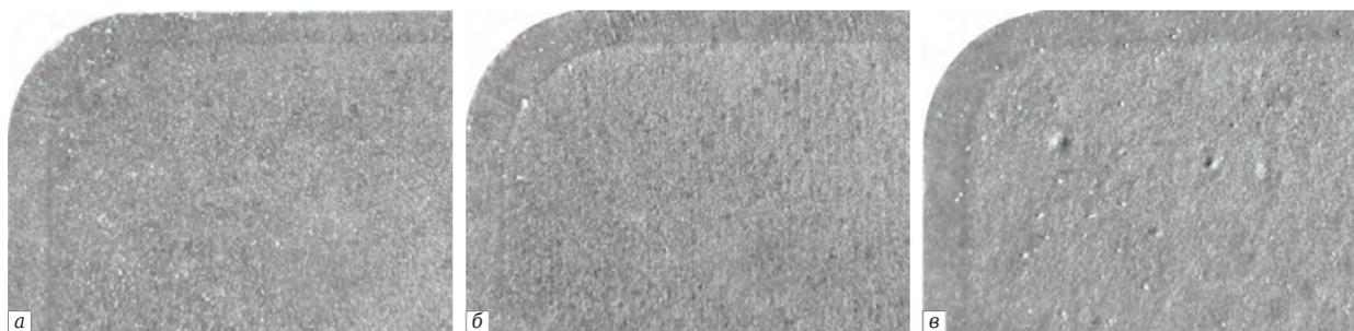
**Рис. 3.** Морфология поверхностей керамических пластин VOK71 после ВАО при режиме: а —  $P = 1,5$  ат,  $\tau = 11$  с; б —  $P = 2$  ат,  $\tau = 22$  с; в —  $P = 2,5$  ат,  $\tau = 33$  с ( $\times 40$ )
