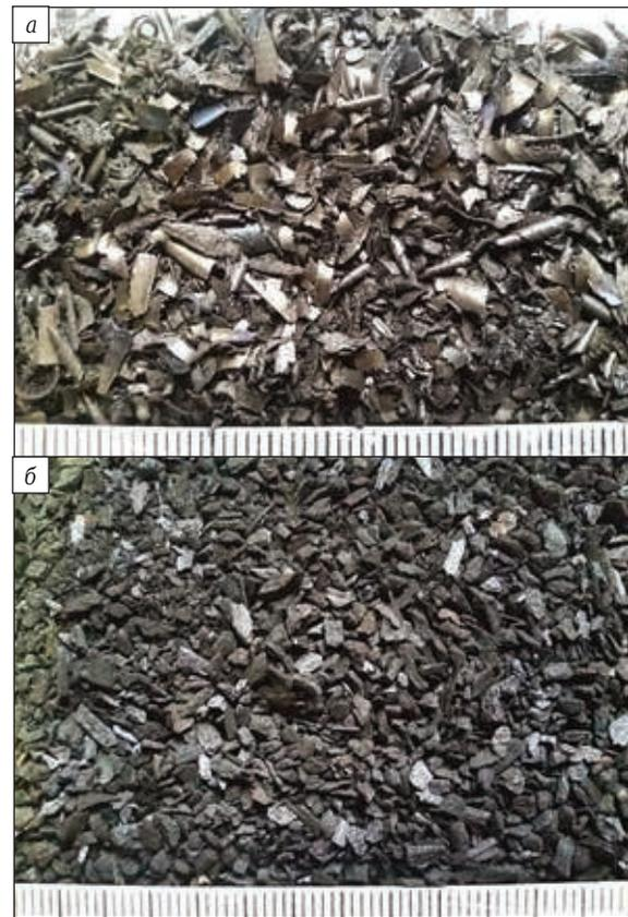
Рис. 2. Образцы частиц неизометрической формы: а — стальная стружка; б — древесный уголь
