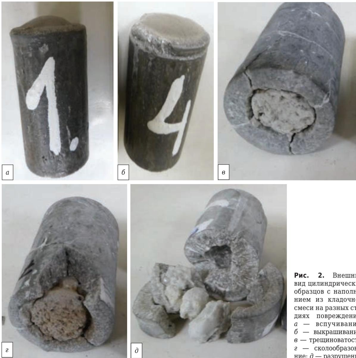
**Рис. 2.** Внешний вид цилиндрических образцов с наполнением из кладочной смеси на разных стадиях повреждения: *а* — вспучивание; *б* — выкрашивание; *в* — трещиноватость; *г* — сколообразование; *д* — разрушение
