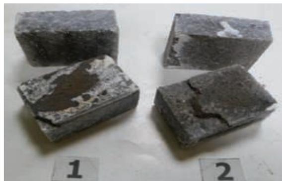
Рис. 1. Образцы соединений изделий из калиевого фторфлогопита после испытаний на терморасплавостойчивость
