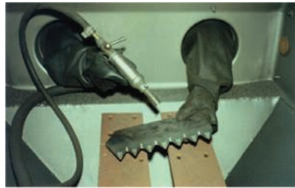
Рис. 1. Струйно-абразивная обработка перед напылением ножа колодезного бура
