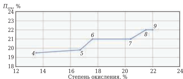
Рис. 2. Зависимость P_{\text{отк}} образцов карбонированных шпинельнокорундовых огнеупоров от степени окисления углерода. Среда — ОК, температура обжига образцов 1300 °С; экспозиция 2 ч; точки 4, 5, 6, 7, 8, 9 соответствуют составам образцов (см. табл. 1)
