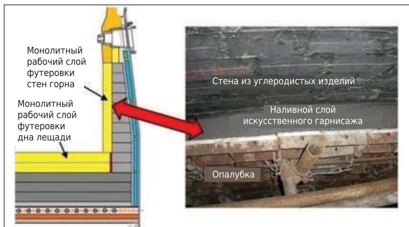
Рис. 17. Монолитный рабочий слой футеровки металлоприемника, охлаждаемый теплопроводной углеродистой футеровкой
