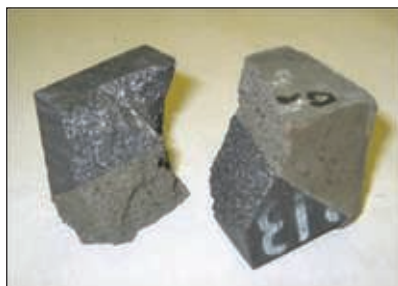
Рис. 8. Прочное соединение бесцементного бетона на золь-гель связке с графитом
