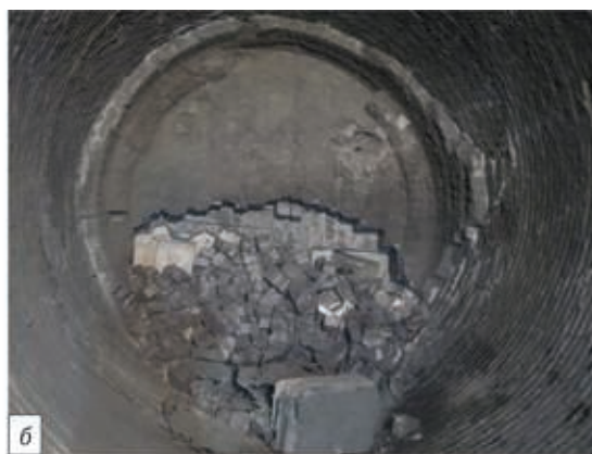
Рис. 3. Общий вид футеровки сталеразливочных ковшей вместимостью 380 т после службы в ККЦ ПАО ММК: а — изделие ПУПК-Д производства ООО «Огнеупор» после 36 плавов, минимальная остаточная толщина футеровки 150 мм; б — изделие АПУ-Д производства ООО «Огнеупор» после 34 плавов, минимальная остаточная толщина футеровки 200 мм
