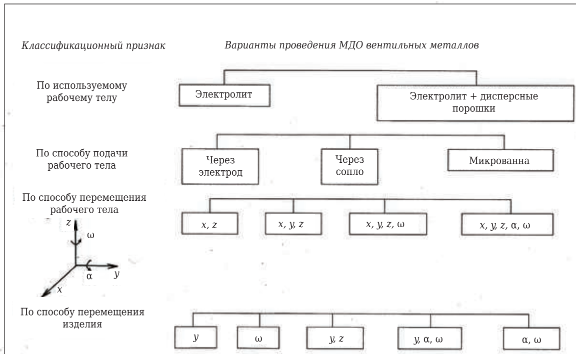
Рис. 2. Классификатор признаков использования МДО проточным способом
