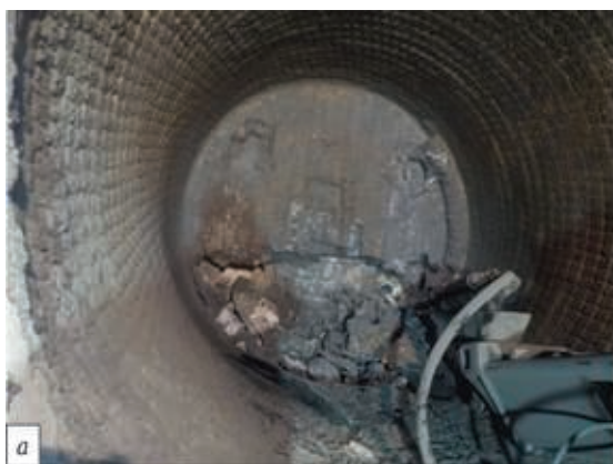
Рис. 3. Общий вид футеровки сталеразливочных ковшей вместимостью 380 т после службы в ККЦ ПАО ММК: а — изделие ПУПК-Д производства ООО «Огнеупор» после 36 плавов, минимальная остаточная толщина футеровки 150 мм; б — изделие АПУ-Д производства ООО «Огнеупор» после 34 плавов, минимальная остаточная толщина футеровки 200 мм
