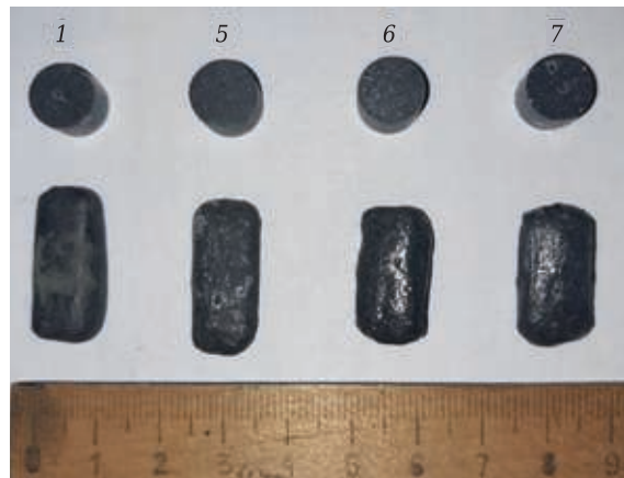
Рис. 7. Компактированные образцы (верхний ряд) и образцы графита с покрытиями составов 1, 5, 6 и 7 (нижний ряд) после нагрева в интервале 1000–1300 °C в течение 2,5 ч с 15-мин выдержкой при 1300 °C
