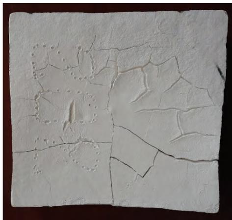
**Рис. 2.** Образец теплозащитного материала на основе волокон  $ZrO_2$  после 2-ч экспозиции при  $1550\text{--}1600$  °С в фокусе БСП
