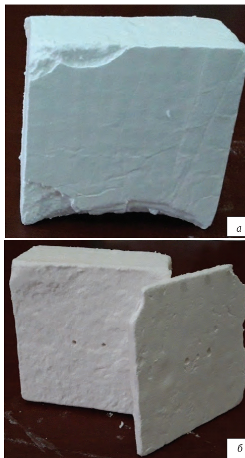
Рис. 2. Образцы теплозащитного материала ВТИ-17 после термообработки в течение 2 ч в фокусе БСП
