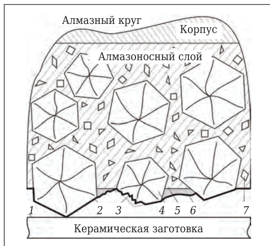
Рис. 2. Схематичное изображение контакта алмазного круга с керамикой
