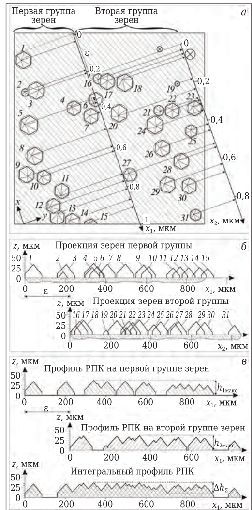
Рис. 4. Топографическая карта (а), проекции зерен (б), поперечные и интегральный профили (в) выделенного участка РП
