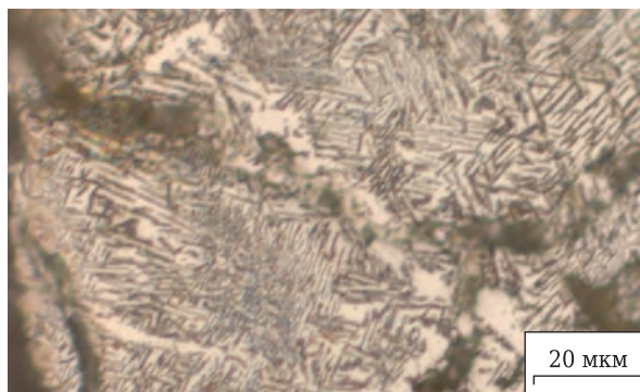
Рис. 7. Микрофотография частиц азотированного образца ФСА при 10 %-ном разбавлении маршалитом
