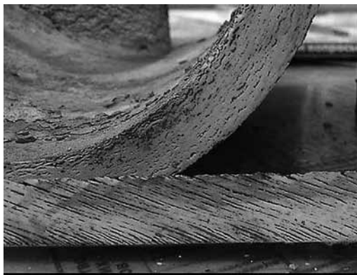
Рис. 6. Поперечное сечение средней части стенки проницаемой диафрагмы с канальной пористостью
