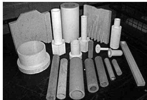
Рис. 4. Керамические изделия ЗАО «НТЦ «Бакор», производимые методом горячего литья
