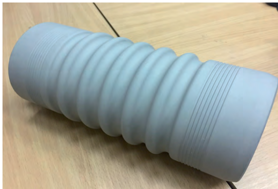
Рис. 9. Алюминиевый пуансон для отливки пластика с МДО-покрытием, полученным в боратном электролите
