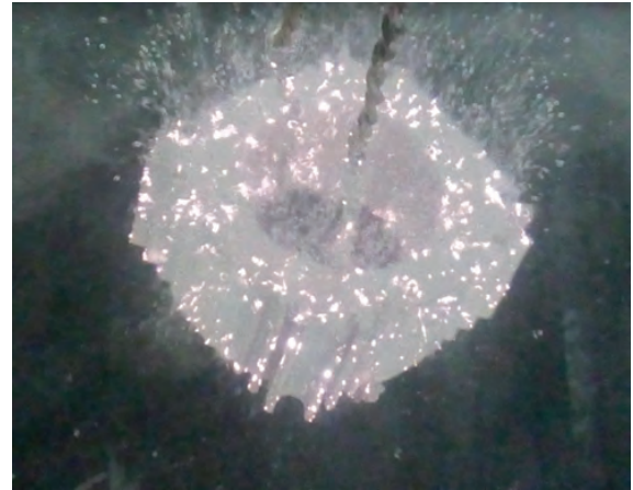
Рис. 5. Микроплазменные разряды на поверхности алюминиевой детали (МДО)
