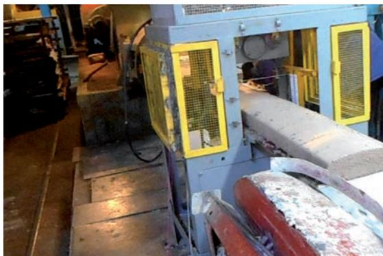
**Рис. 3.** Резательный автомат РАШЛ-3
