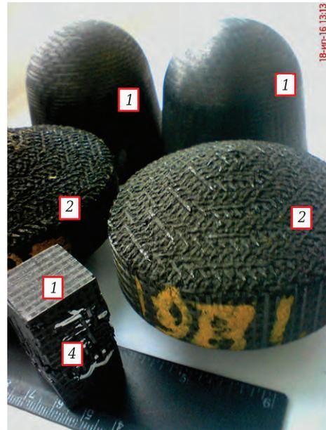
Рис. 6. Детали из УУКМ: 1 — исходные детали после механической обработки поверхности; 2 — поверхности после эксплуатации; 3 — механически разрушенный образец после определения предела прочности при сжатии
