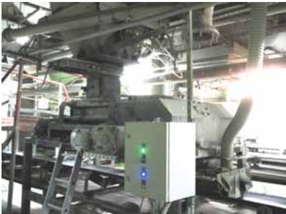
Рис. 3. Питатели молотой глины с регулируемой подачей порошка на ленту
