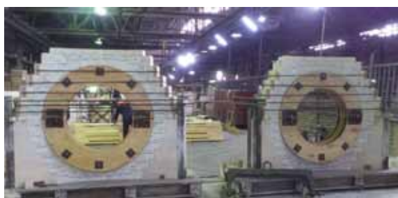
Рис. 7. Стендовая сборка арок воздушного коллектора форкамеры воздухонагревателя Калугина
