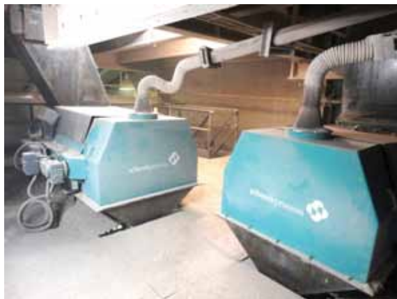
Рис. 2. Дозаторы «Мультидоз» фирмы «Шенк» на отметке 23 м формовочного участка ЦСП
