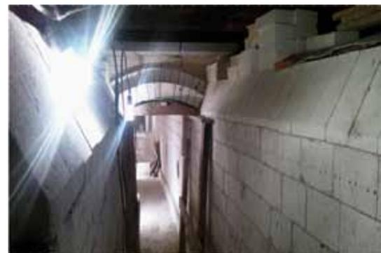
Рис. 2. Футеровка безмуфельной электрической печи ОАО «Металлургический завод «Электросталь»
