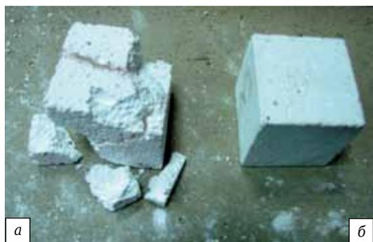
**Рис. 4.** Результат испытания на термостойкость изделий КТ-1,3 (а) и НК-29 (б)
