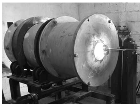
Рис. 1. Лабораторная печь для определения шлакоустойчивости
