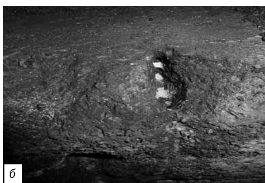
Рис. 5. Механизм образования локального износа вследствие обезуглероживания: а — вид сверху; б — вид сбоку
