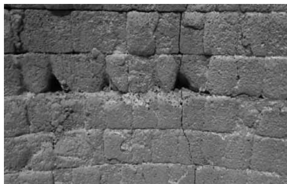
Рис. 1. Локальный (дырочный) износ периклазоуглеродистой футеровки сталеразливочного ковша
