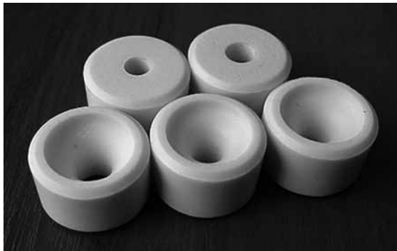
Рис. 6. Дюзы для риммеров подземной проходки грунтов
