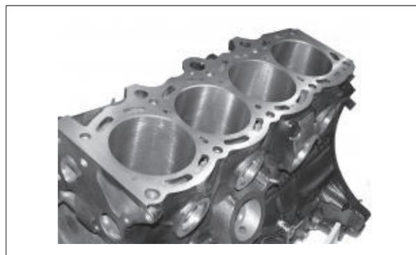
Рис. 1. Четырехцилиндровый блок ДВС
