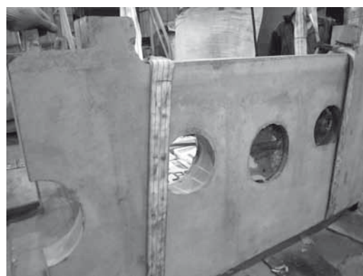
Рис. 3. Элемент крышки для промежуточного ковша, футерованной по бетонной технологии
