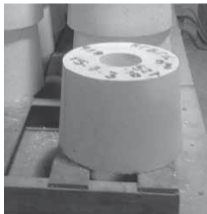
Рис. 1. Корундовый бетонный гнездовой блок
