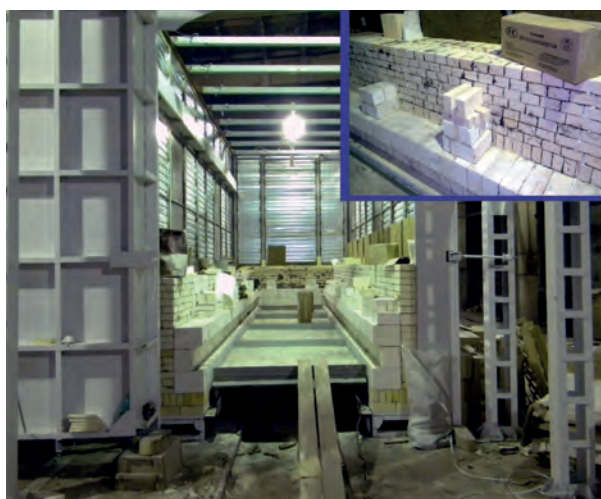
Рис. 6. Речицкий фарфоровый завод, периодическая печь (проект компании «Теплохиммонтаж»)
