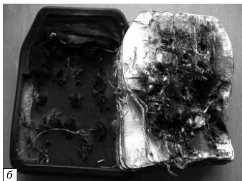
Рис. 5. Внешний вид бронепанели № 2 после баллистических испытаний: а — лицевая сторона; б — тыльная сторона
