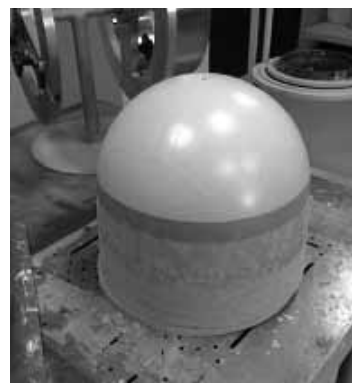
Рис. 5. Макет трехслойного теплозащитного экрана из неорганического стеклопластика
