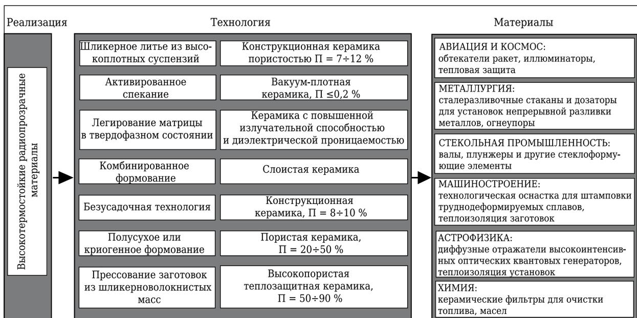
**Рис. 8.** Области применения керамических материалов на основе аморфного диоксида кремния
