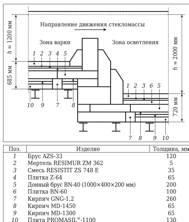
Рис. 1. Фрагмент продольного сечения варочного бассейна
