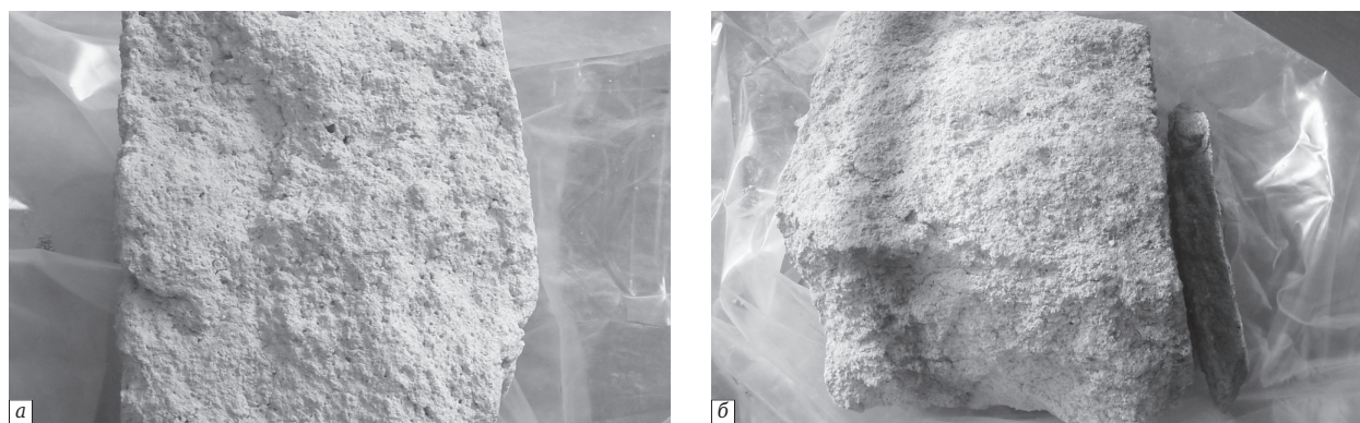
Рис. 1. Образцы футеровки керамического тигля после эксплуатации: а — зона выше уровня металла; б — зона на уровне металла
