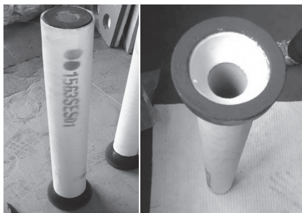
Рис. 1. Прямоточный погружаемый стакан «холодного» старта компании «Corwintec»
