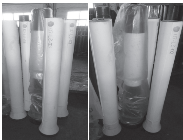
Рис. 6. Труба для защиты струи металла в изолирующем фетре
