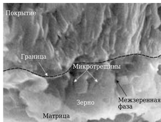
Рис. 1. Микрофотография области контакта керамики ВОК71 с покрытием TiN
