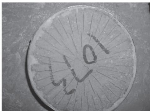
Рис. 6. Продувочные пробки с радиальным расположением продувочных каналов
