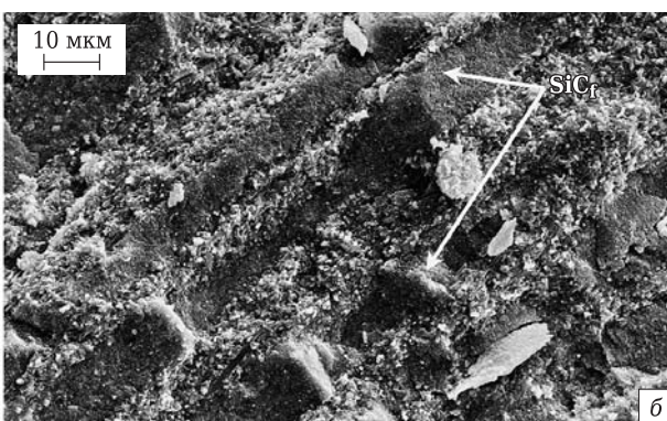
Рис. 5. Ориентация \text{SiC}_f в матрице параллельно (а) и перпендикулярно (б) усилию горячего прессования
