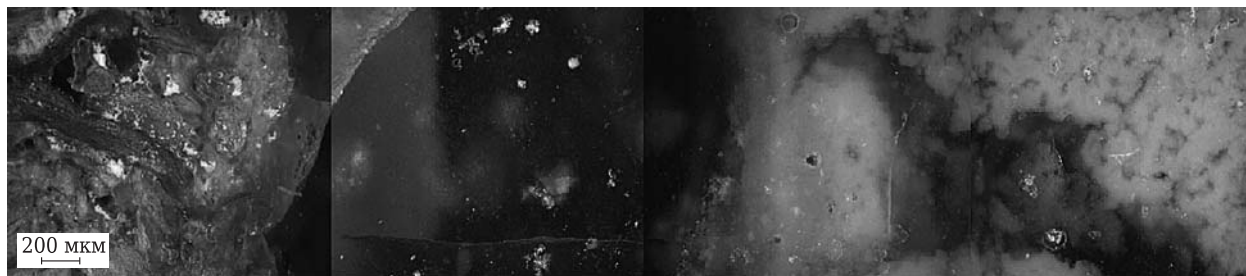
Рис. 6. Панорамный снимок раздела фаз образца огнеупора
