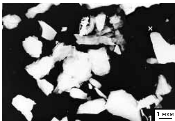
Рис. 1. Электронный микроснимок пирофиллитовой породы. \times 5000
