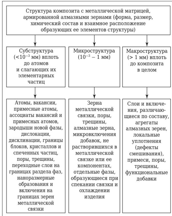
Рис. 5. Классификация элементов структуры композита с металлической матрицей, армированной алмазными зернами (рабочий слой РИ)
