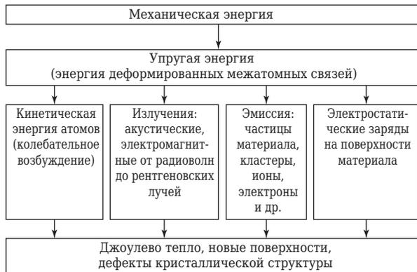
Рис. 12. Схема превращений механической энергии, подводимой к твердому телу [16]
