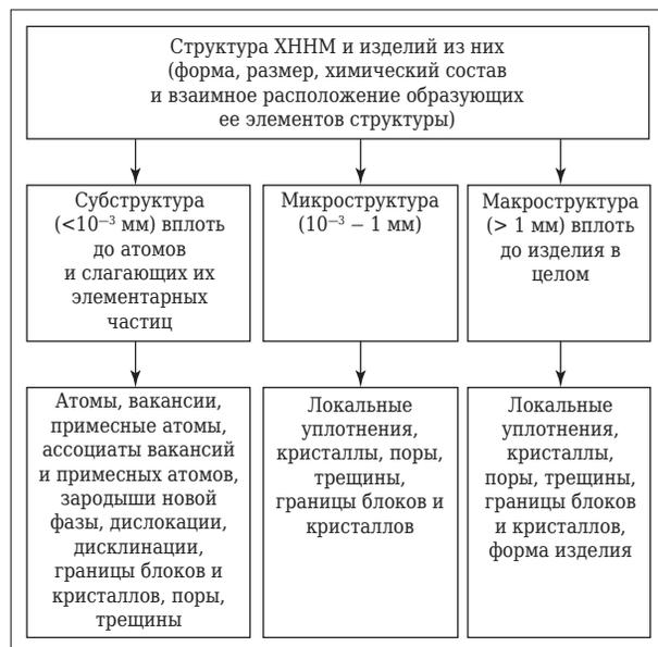
Рис. 4. Классификация элементов структуры, составляющих ХННМ [10]
