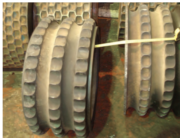
Рис. 2. Формующий инструмент валкового пресса серии ПБВ (бандаж)
