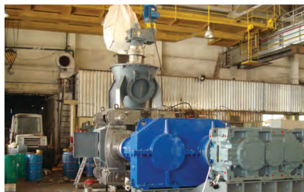
Рис. 1. Валковый брикетировочный пресс ПБВ-1000/420-400П для окускования отсевов извести (основной привод с редуктором, клеть, бункер и привод подпрессовщика)
