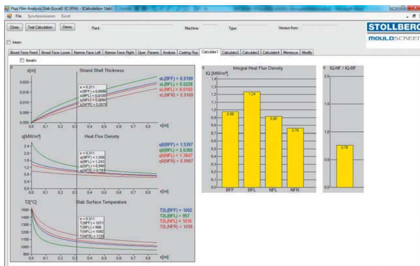
Рис. 5. Экран вывода данных: толщины поверхностного слоя заготовки, температуры поверхности слэба, локальной и интегральной плотности теплового потока через активную длину кристаллизатора
