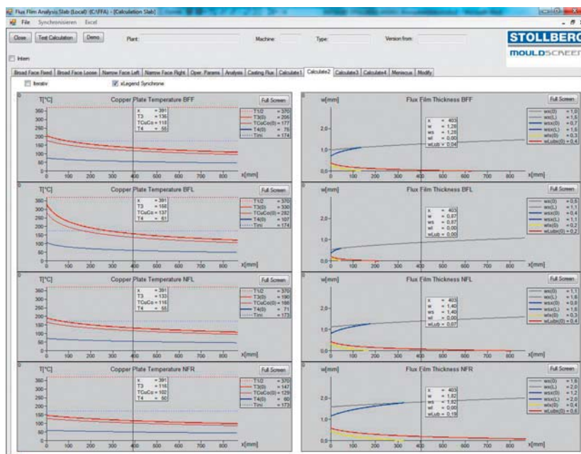
Рис. 6. Экран вывода данных: температуры медной холодильной плиты, показаний термопары, толщины шлаковой пленки, состояния шлака
