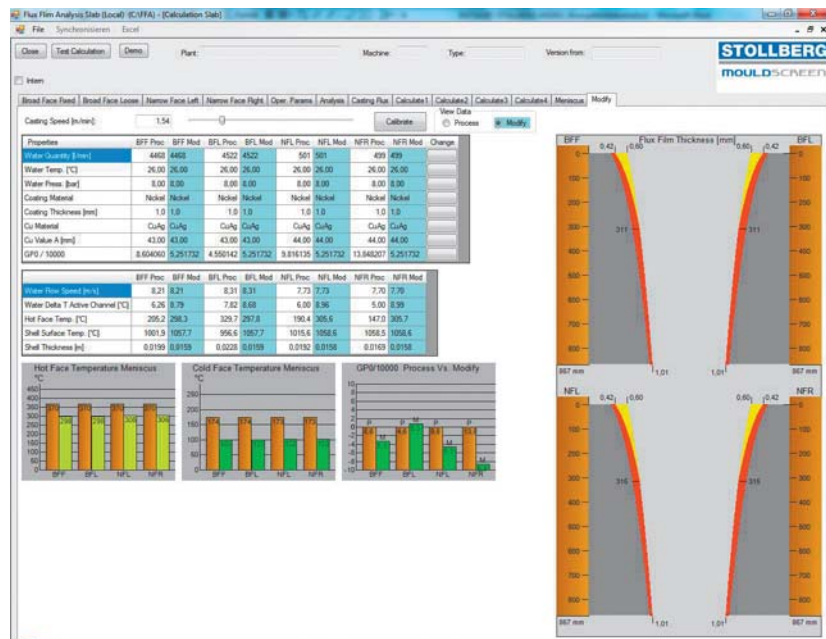
Рис. 7. MouldScreen® Modify tool выводит на экран вариации изменений эксплуатационных параметров МНЛЗ и их воздействие на температуру медной холодильной плиты, а также на фазы состояния шлаковой пленки (твердое, кашеобразное или жидкое)
