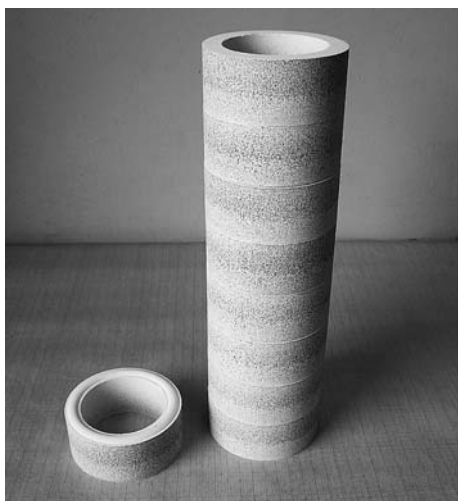
Рис. 3. Термостойкие керамические охранные кольца на основе титаната алюминия
