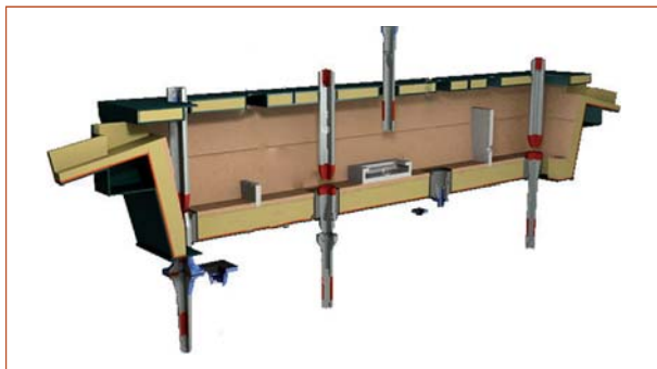
Рис. 8. Промежуточный ковш МНЛЗ с установленными огнеупорными изделиями для изменения направления потоков металла
