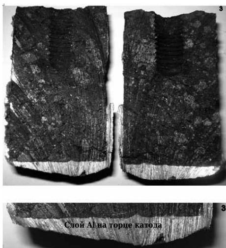
Рис. 1. Поверхность катодной футеровки при контакте со слоем алюминия
