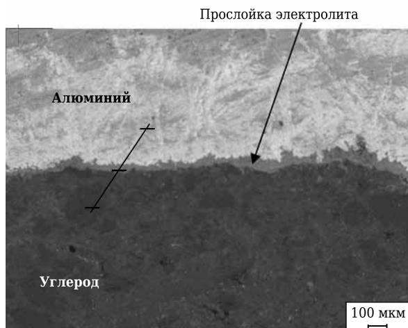
Рис. 2. Микроструктура образца при контакте расплава с образцом.  $\times 55$
