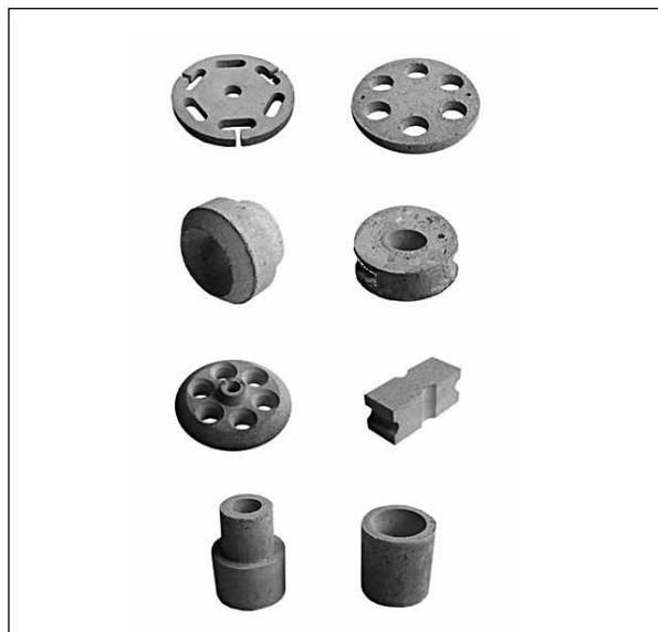
**Рис. 1.** Фасонные мелкоштучные электроизоляционные изделия
