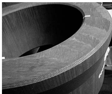
Рис. 1. Крупногабаритная заготовка из трехмерноармированного УУКМ; диаметр стержня ячейки композита 1,22 мм
