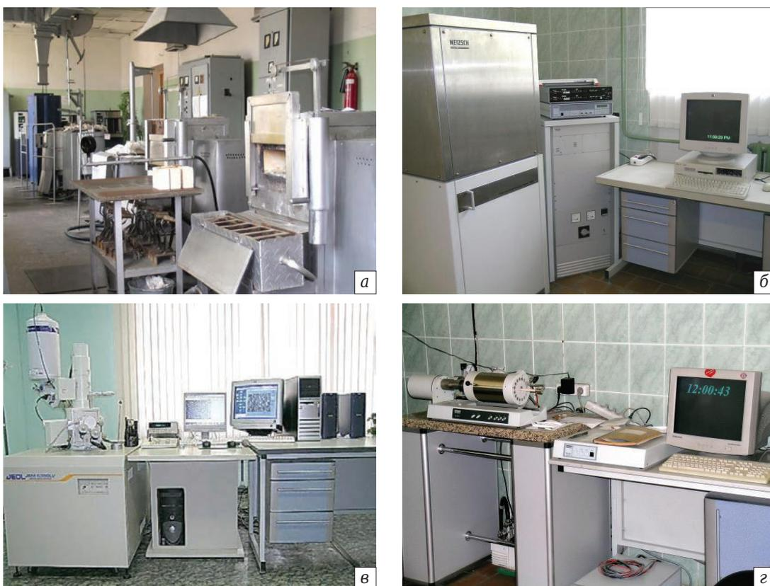
**Рис. 1.** Элементы научно-технической базы ЦСТП: а — лаборатория термических испытаний; б — установка для определения теплопроводности; в — система электронной микроскопии «Jeol 6380 LV»; г — установка для определения ТКЛР
