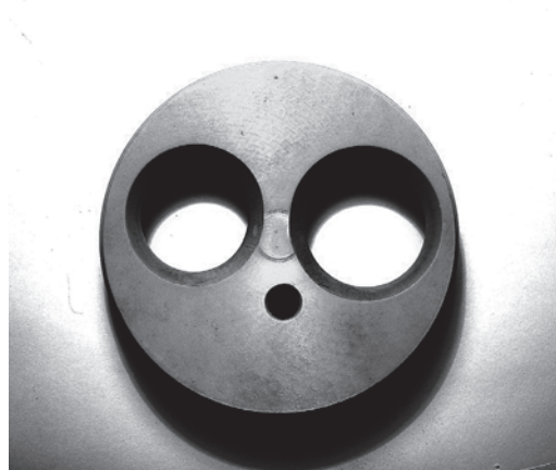
Рис. 3. Керамическая головка цилиндра из титаната алюминия
