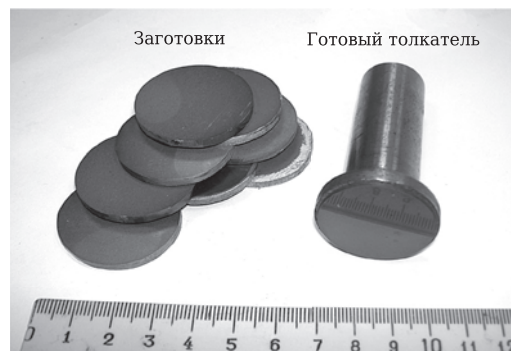
Рис. 5. Керамические заготовки и толкатель клапана с нитридкремниевым рабочим телом
