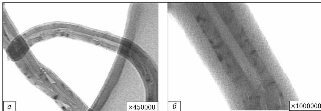
Рис. 3. Структура нанотрубок после 27 ч механоактивации (ПЭМ): а — «вложенные конусы»; б — «бамбук»
