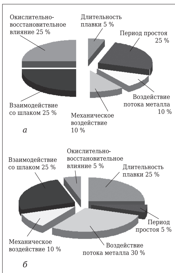
Рис. 2. Распределение факторов, влияющих на стойкость футеровки вакууматоров № 1 (а) и № 2 (б)
