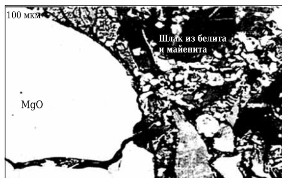
Рис. 2. Зона взаимодействия периклазового огнеупора с глиноземистым ковшевым шлаком
