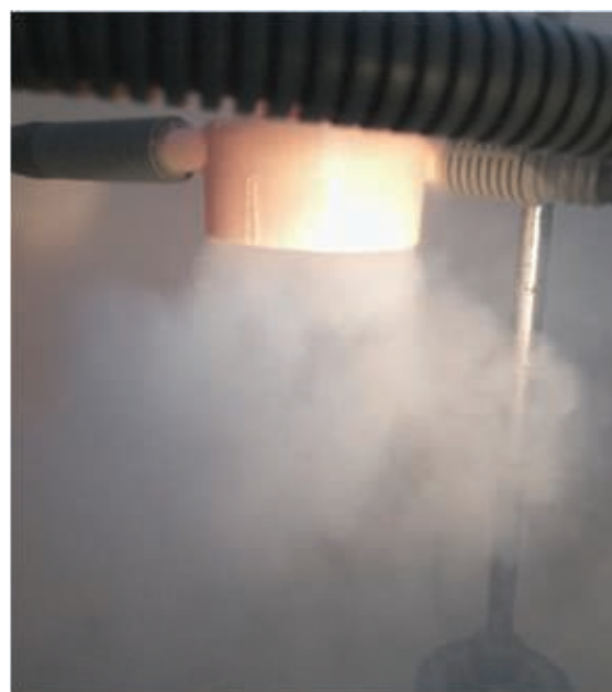
Рис. 5. Визуализация воздушного течения вблизи вихревого отсоса
