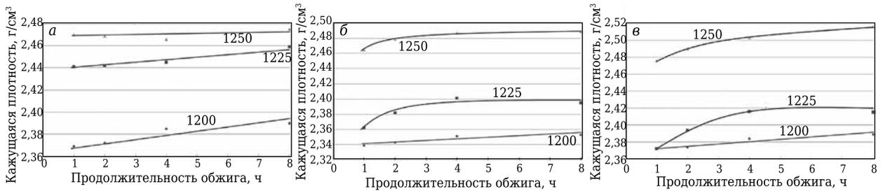
Рис. 1. Зависимость кажущейся плотности материалов ОТМ-357 (а), 357-С (б) и ОТМ-357-О (в) от температуры (указана на кривых, °С) и продолжительности обжига
