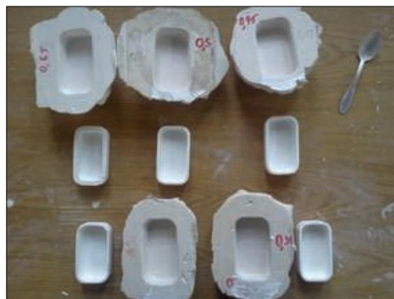
Рис. 1. Гипсовые формы и отлитые заготовки лодочек
