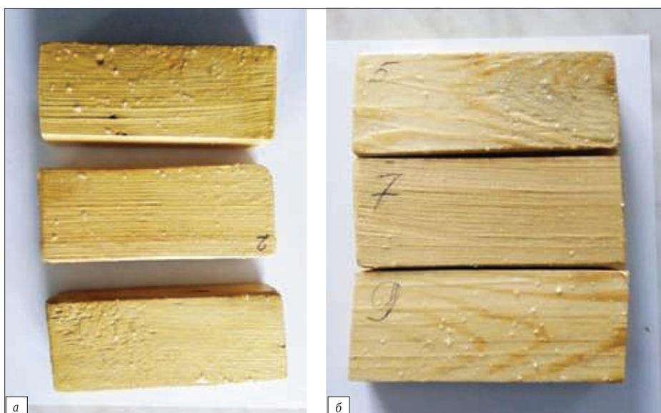
**Рис. 1.** Образцы после нанесения одного (а) и двух слоев (б) огнеупорного состава
