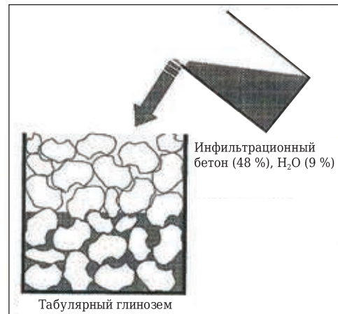
Рис. 13. Принцип, положенный в основу технологии InfilCast
