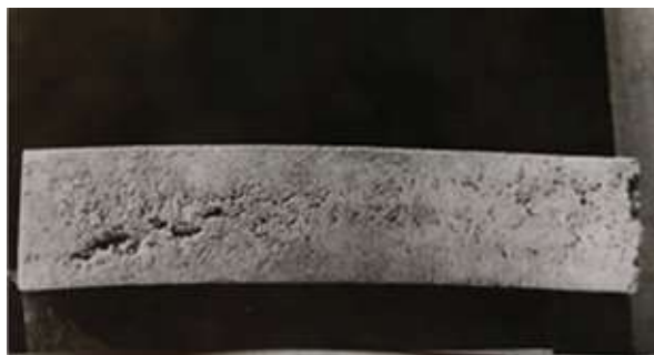
Рис. 2. Сырец, полученный при недостаточной продолжительности виброуплотнения
