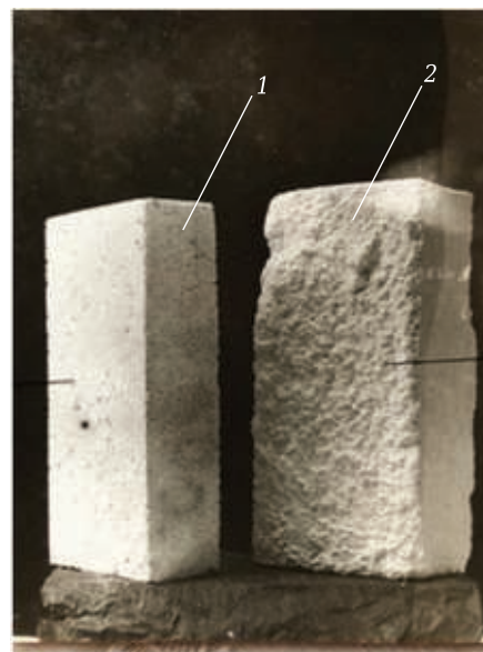
Рис. 3. Корундовые теплоизоляционные изделия, полученные методом выгорающих добавок, при разном способе формования: 1 — изделие ячеистое вибропневмоуплотненное (на пенополистироле) с четкими ребрами и гранями, не требующее обрезки и шлифования ( 700 \text{ кг/м}^3 ); 2 — изделие литое (на опилках), требующее обрезки и шлифования ( 1300 \text{ кг/м}^3 )
